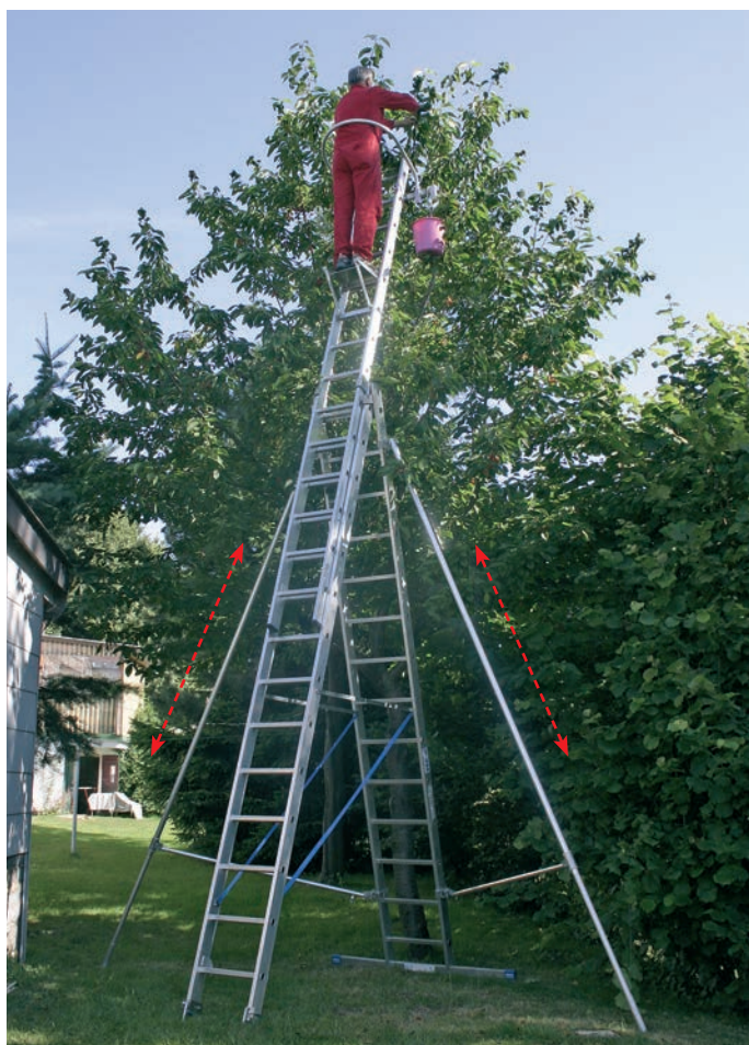
Výřez stabilizační opěry pro víceúčelové a mnohoúčelové žebříky (otočné)
