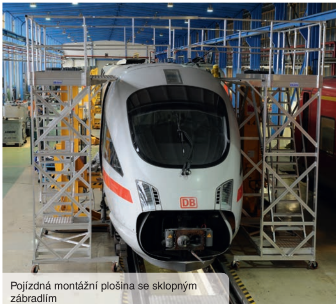
Pohyblivá plocha s ochrannou mříží a sklopným zábradlím
